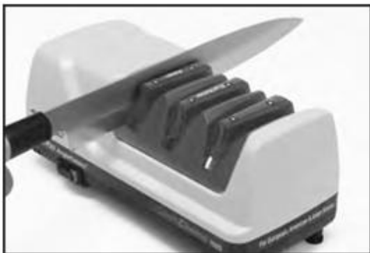
Kuva 11 Teroita traditionaalinen oikeakätinen japanilaisveitsi vain vaiheen 1 vasemmassa hahlossa.
