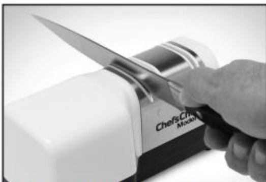
Kuva 1. Veitsen asettaminen vasemman puoleiseen hahloon vaiheessa 1.
